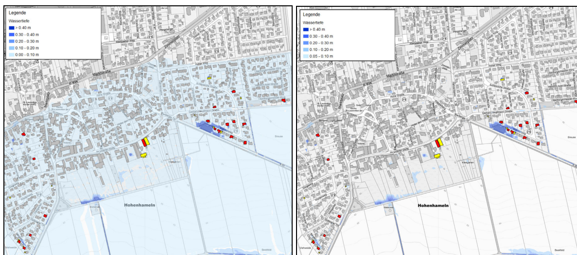
Abb. 8.1: Überschwemmungsflächen: links: gesamte Überschwemmungsfläche; rechts: Flächen mit einer Mindestwassertiefe von 5 cm und betroffene Gebäude
