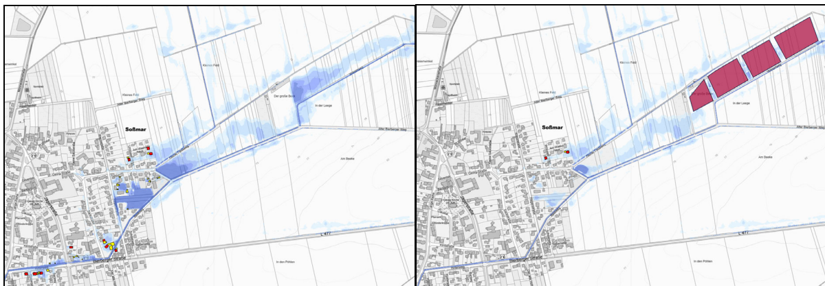
Abb. 8.13: Vergleich HQ 30 ohne (links) und mit Polder (rechts)
